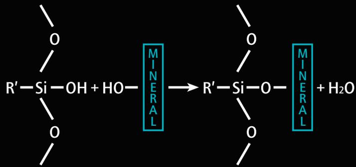
Silanierungsreaktion an der Mineraloberfläche
